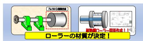
スタッフに勉強会を開いてもらう事に。炉内で使用する事も有り材質は耐熱鋼を使用する事にしました。耐熱鋼の種類も多くあり、特徴もそれ違う事が解かりました。大久保技術員に相談し、最適なローラーの材質条件を教えてもらうことになりました。コスト面も考慮した結果耐酸化・化・高強度に特徴の有る鉄・ニッケル・クロム耐熱合金を採用とし、ローラーの材質が決定、耐熱鋼ローラーの図面も完成しました。
