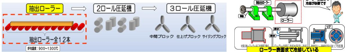
抽出ローラーの役割を説明します。抽出ローラーは、加熱炉内で加熱された鋼片を、圧延機へ搬送する設備で、全部で12本あり、加熱炉内温度は900°C~1300°Cで常に高温化の中にある設備です。次に構造を説明します。抽出ローラーは、炭素鋼で作られており、内部に冷却水を流し、表面まで冷却しています。また強度上昇・接続の為リブを配置しております。
