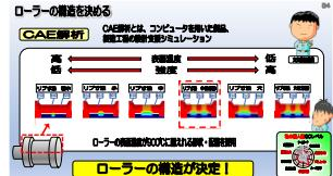
81号炉を参考に、耐熱鋼での無水冷案を会議にて提案。水を流さないで、冷却水損失熱抑制効果が期待されると思い、大久保技術員に強度計算を依頼！しかし、表面温度が高くなりすぎるといわれ、断念。軸とローラーの隙間に断熱材を入れてリブで補強する案で再度、大久保技術員に図面・強度計算を依頼しました。
