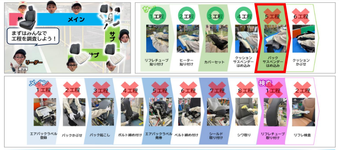
サブ5工程からスラブ折れが発生
