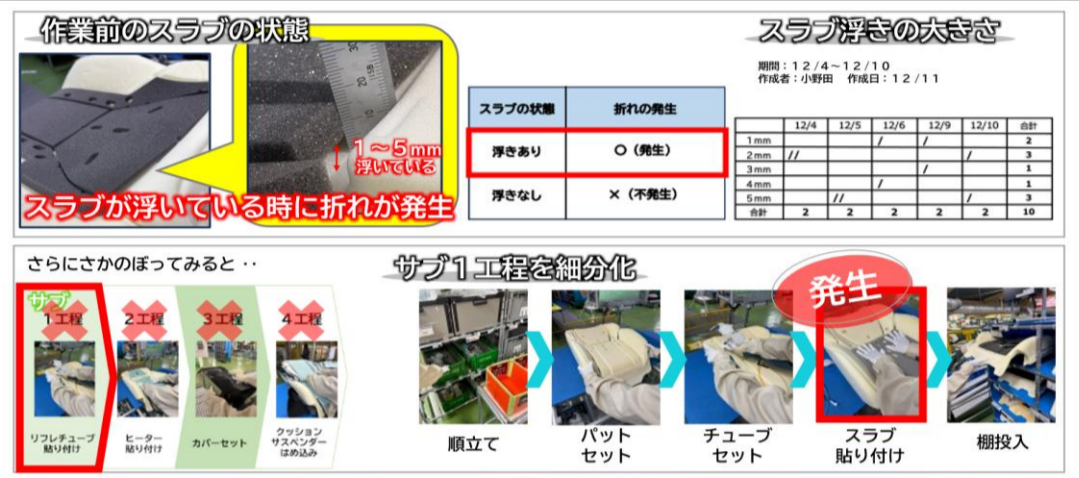
スラブが浮いている時に折れが発生
