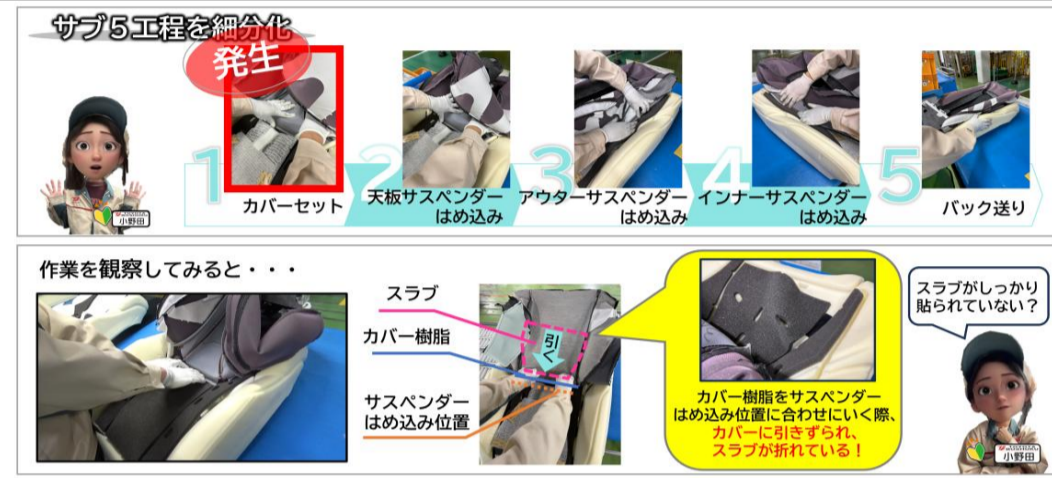
カバーに引きずられ、スラブが折れている
